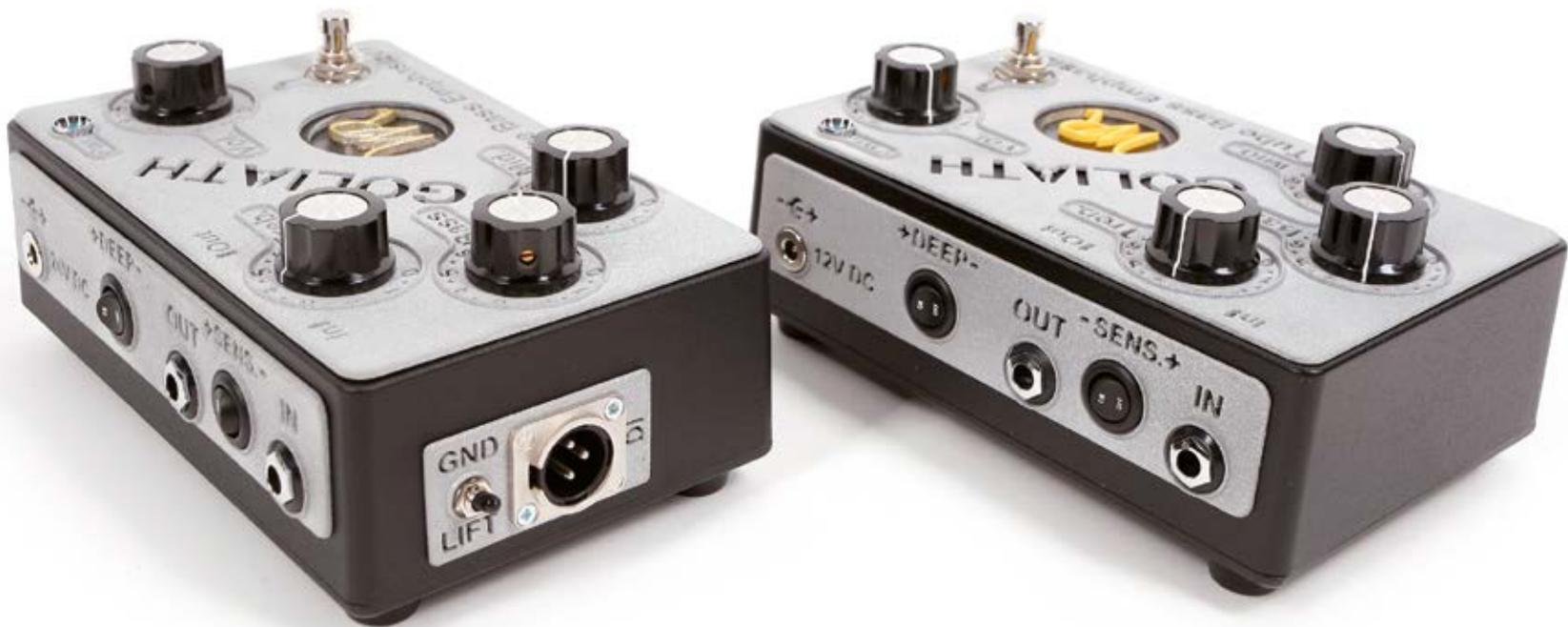
Roland Weiland aus Luxemburg, der Mann hinter WR Amplification, mag Röhren, baut Pedale und printed gerne 3D. Teile von Gehäusen, zum Beispiel die für seine zwei neuen Tube Emphasizer Pedale. Diese Preamps werden in kleiner Stückzahl von Hand gefertigt und Point-to-Point verlötet. Da schlägt das Röhrenherz gleich etwas höher.
